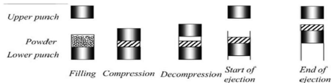
**Fig. 2:** Compression Process<sup>19</sup>
