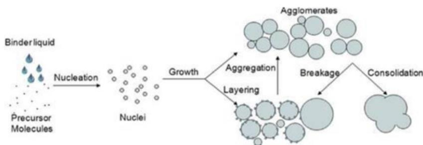
**Fig. 6:** Over granulating process<sup>35</sup>
